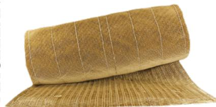
**Composizione****Reazione al fuoco****Classe di efficienza EN 779****Classe di efficienza ISO 16890****Portata aria (a 1,5 m/s)****Perdita di carico iniziale (a 1,5 m/s)****Perdita di carico finale consigliata****Imballo****Strati di carta Kraft****Brucia <sup>(4)</sup>****G4****Coarse 30%****675 m<sup>3</sup>/h****9,5 Pa****130 Pa****Sacco in polietilene****Legenda**
